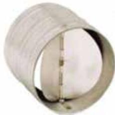
C'est un accessoire du réseau aéraulique utilisé pour le blocage de l'entrée d'air en cas d'arrêt du caisson de ventilation. Il est composé d'un corps circulaire en acier galvanisé et de deux volets munis de ressorts qui se ferme dès que le ventilateur cesse de fonctionner. Il est fait en tôle acier galva Z100 épaisseur 8/10.
