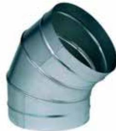
Le coude galva 45° est un accessoire pour réseau aéraulique utilisé pour le changement de direction (gauche, droite, haut & bas) sur un angle de 45°. Il est fait en tôle acier galva Z100 épaisseur 8/10
