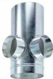
C'est un accessoire de réseau aéraulique qui permet de raccorder sur un même plancher un à quatre piquages sur une colonne montante verticale. Il garanti une mise en oeuvre sans fuite ni perte de charge excessive sur les piquages. Il est fait en tôle acier galva Z100 épaisseur 8/10.
