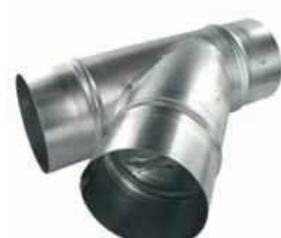
C'est une pièce du réseau aéraulique qui permet le raccordement de deux branches du réseau avec un angle de 45°. Il est fait en tôle acier galva Z100 épaisseur 8/10.
