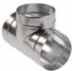
C'est une pièce du réseau aéraulique qui permet le raccordement de deux branches du réseau avec un angle de 90°. Il est fait en tôle acier galva Z100 épaisseur 8/10.
