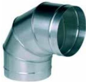
Le coude galva 90° est un accessoire pour réseau aéraulique utilisé pour le changement de direction (gauche, droite, haut & bas) sur un angle de 90°. Il est fait en tôle acier galva Z100 épaisseur 8/10
