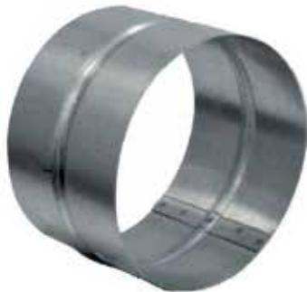
Le manchon femelle est un connecteur. Il sert principalement à assembler deux gaines circulaires. Il est fait en tôle acier galva Z100 épaisseur 8/10.
