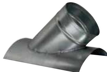
C'est une pièce de raccordement qui permet de réaliser un piqueage à 45° sur une gaine circulaire. Il est fait en tôle acier galva Z100 épaisseur 8/10.
