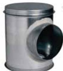
C'est un accessoire de réseau aéraulique utilisé pour le raccordement des colonnes montantes verticales sur les réseaux horizontaux disposés en terrasse, en toiture ou dans les combles. Il est équipé d'un bouchon permettant la visite. Il est fait en tôle acier galva Z100 épaisseur 8/10.
