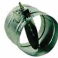
C'est un accessoire de réseau aéraulique qui permet de réguler manuellement le flux d'air. Il est utilisé pour l'équilibrage des réseaux de ventilation. Il est fait en tôle acier galva Z100 épaisseur 8/10.
