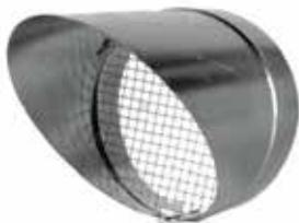
C'est un accessoire de réseau aéraulique utilisé pour l'aménée d'un air neuf ou le rejet d'air vicié. Il est posé horizontalement et à l'extérieur. Son grillage en fil d'acier galvanisé permet une résistance volatile indésirable. Il est fait en tôle acier galva Z100 épaisseur 8/10.
